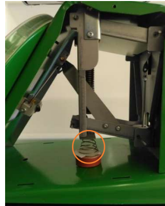
図4 円錐コイルばねを組み込んだ上皿式秤の内部
