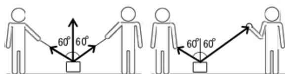
(a) 分力の大きさ支える力よりも小さい (b) ひもが長いほど分力の大きさが大きくなる
